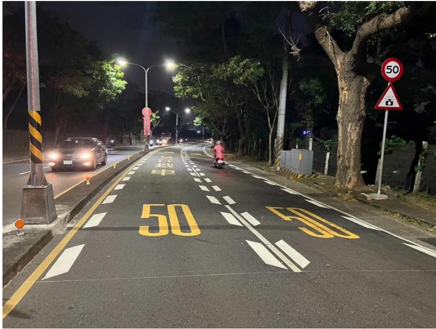
圖十：視覺化減速標線、反光導標及速限標誌／線
