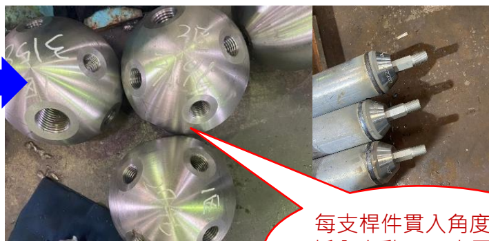
原設計鋼球接合示意圖
