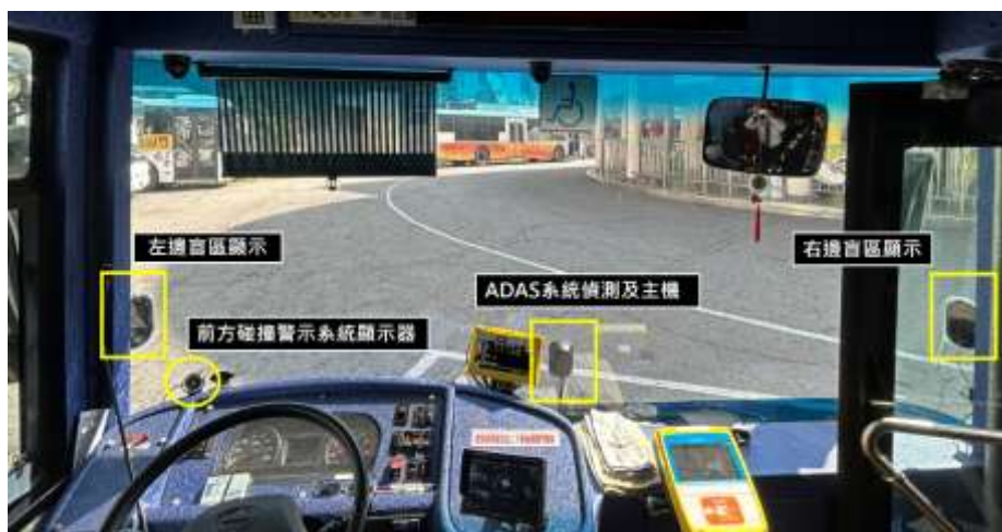
圖 2、公車裝設先進駕駛輔助系統(ADAS)
