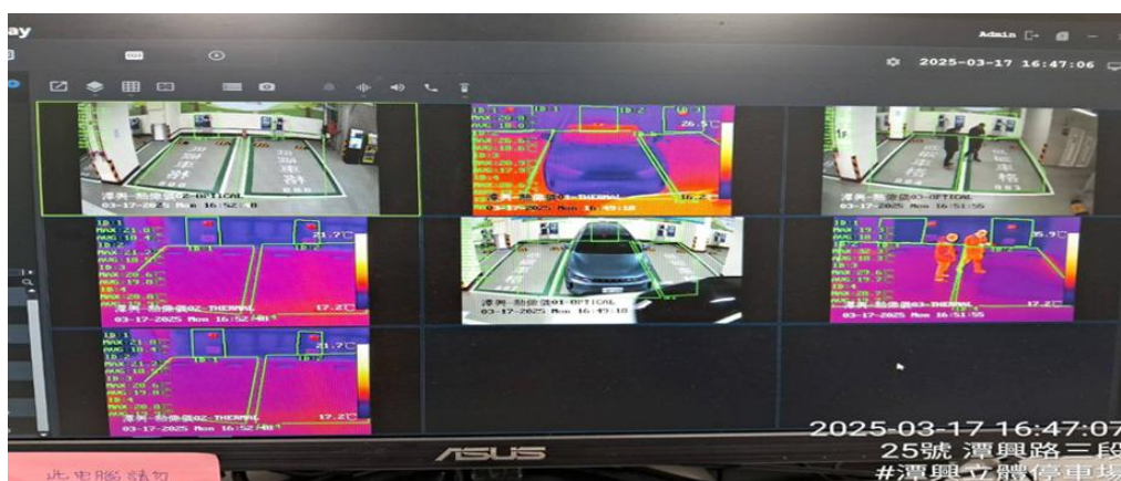
圖 17、潭興停車場試辦「熱顯像儀」及「低壓細水霧消防設備」
