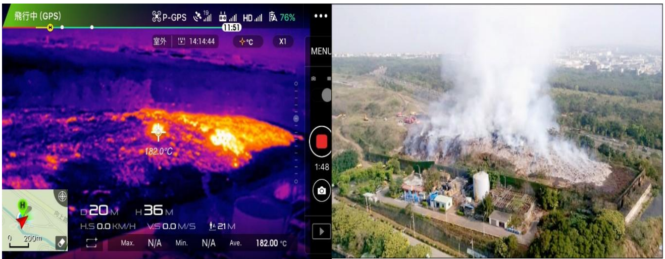
圖六 空拍機拍攝熱影像與火警現場地形情形。
