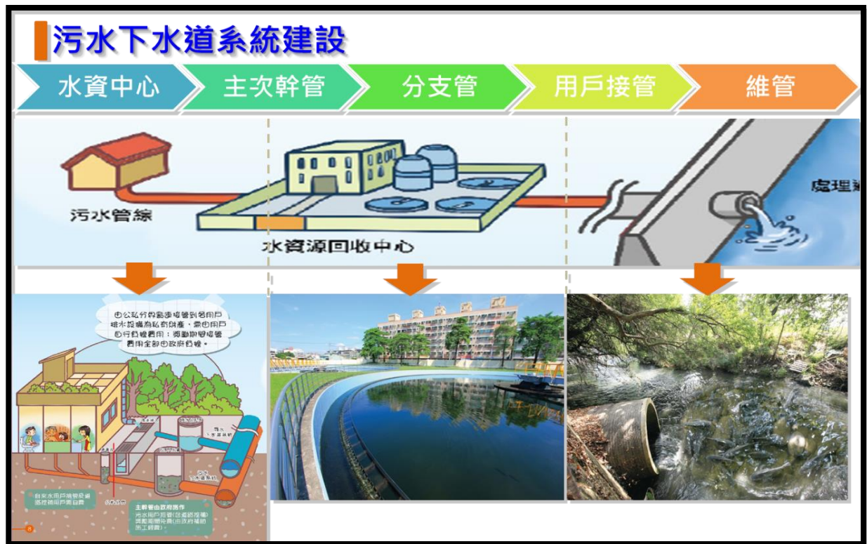
污水下水道系統建設順序示意圖
