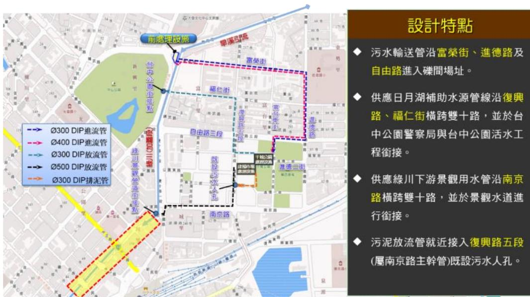
圖 6.礫間場及污水管線配置位置
