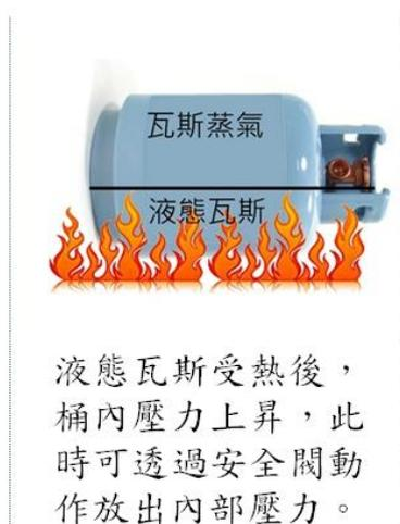
液態瓦斯受熱後，桶內壓力上昇，此時可透過安全閥動作放出內部壓力。
