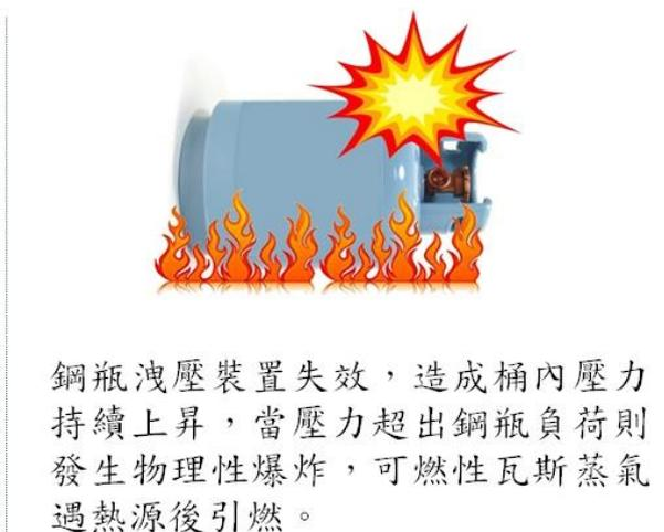
鋼瓶洩壓裝置失效，造成桶內壓力持續上昇，當壓力超出鋼瓶負荷則發生物理性爆炸，可燃性瓦斯蒸氣遇熱源後引燃。
