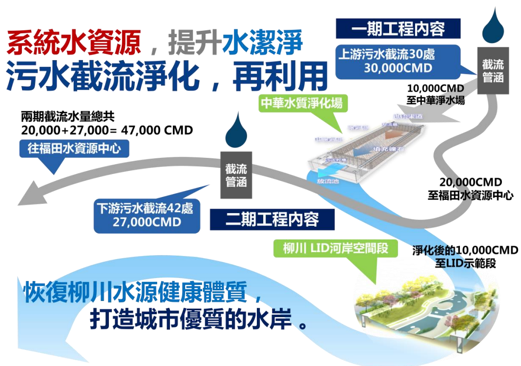
圖 7. 污水截流系統示意圖
