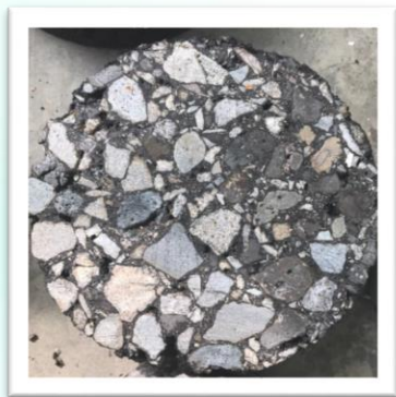
轉爐石粒料方正及堆積緊密
