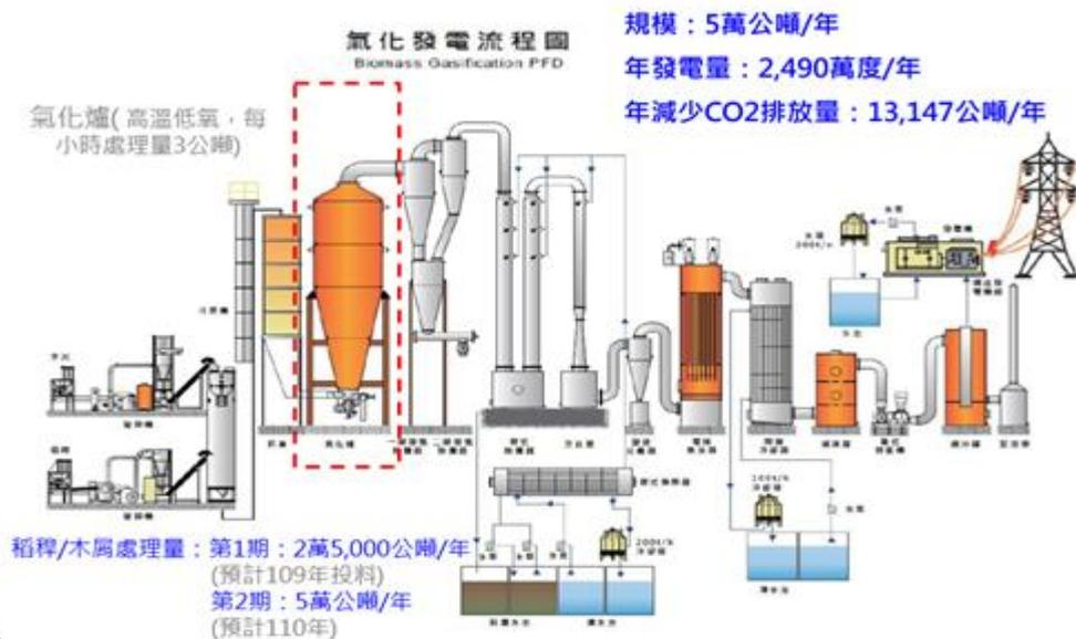
圖 2-2 氣化爐技術流程(料源為稻稈/木屑)
