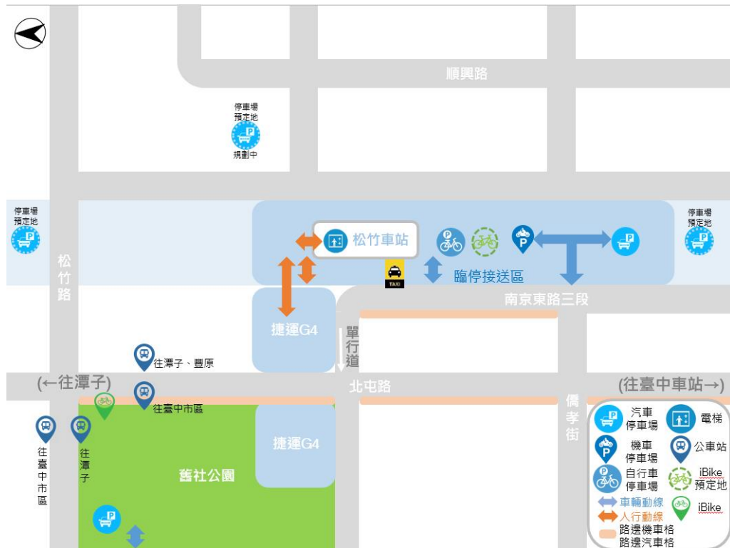
圖 2.4.8 松竹車站周邊運具配置與人行動線規劃示意圖
