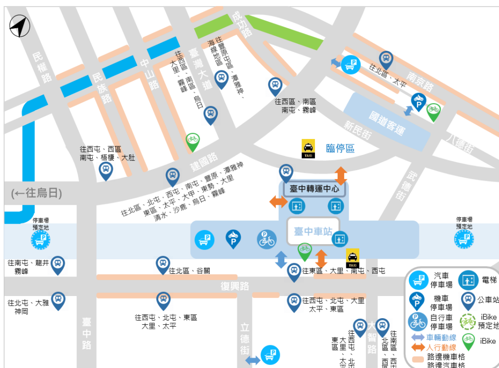
圖 2.4.4 臺中車站周邊運具配置與人行動線規劃示意圖
