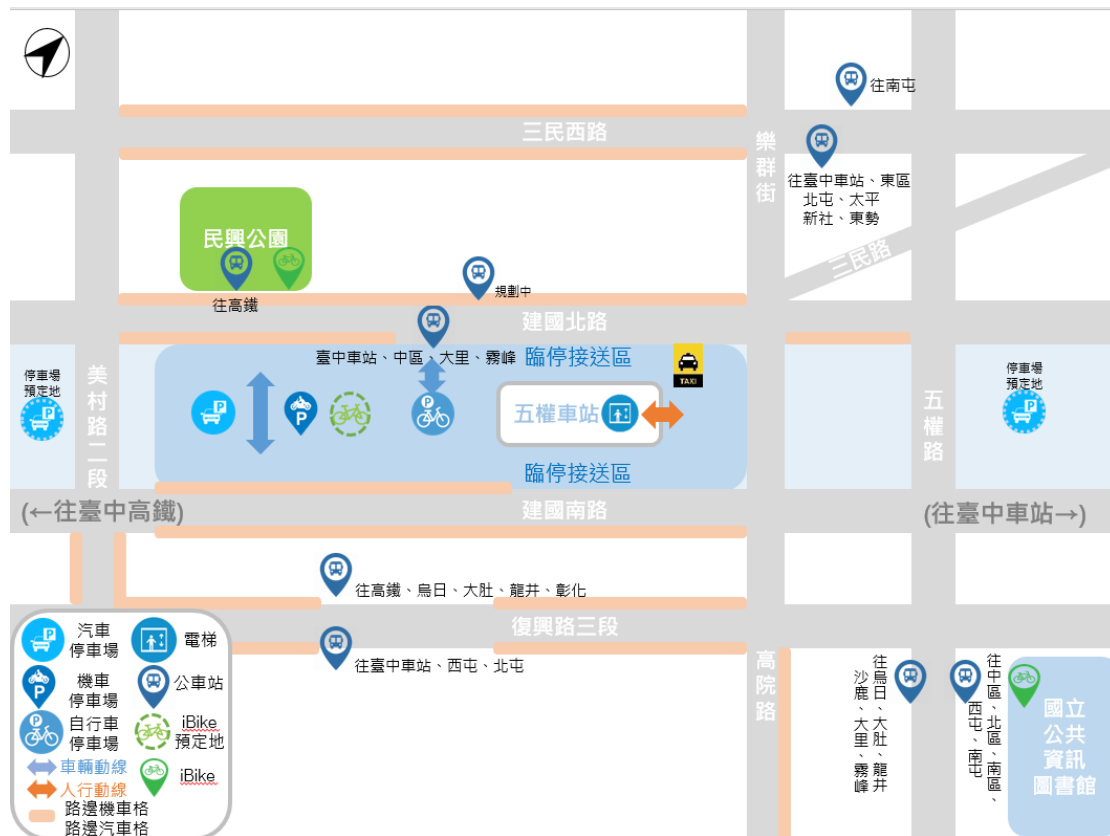
圖 2.4.10 五權車站周邊運具配置與人行動線規劃示意圖
