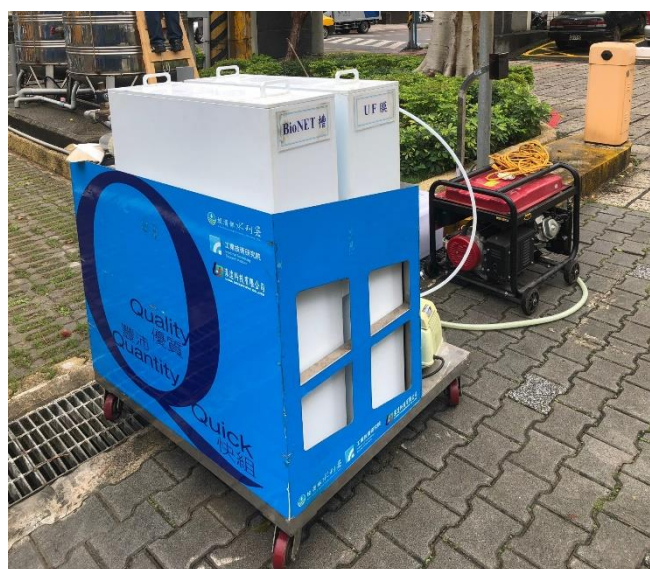
Q-water 淨水設備
