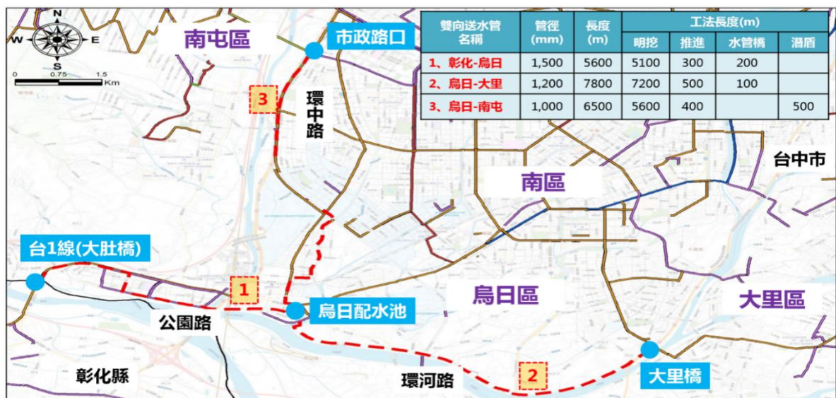
圖三 臺中-彰化雙向調度管線改善工程
