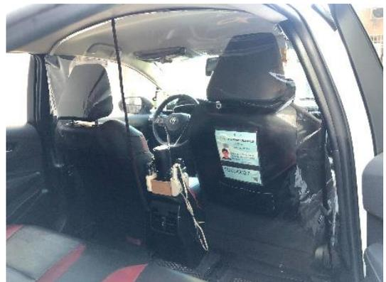
圖33、防疫計程車防護裝備及安全透明隔廉
