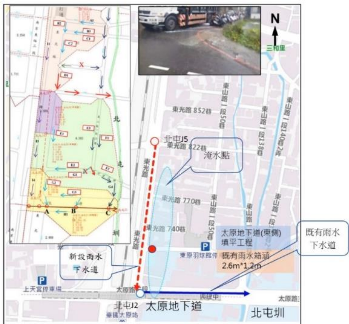
東光路雨水下水道工程預定路線圖
