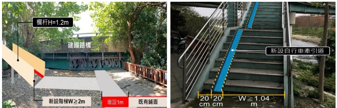
圖 18 新設爬坡道及牽引設施跨越路橋(示意圖)
