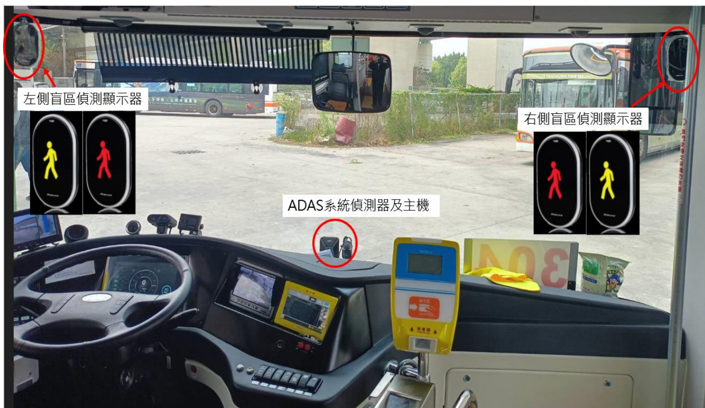
圖 3 先進駕駛輔助系統設備示意圖
