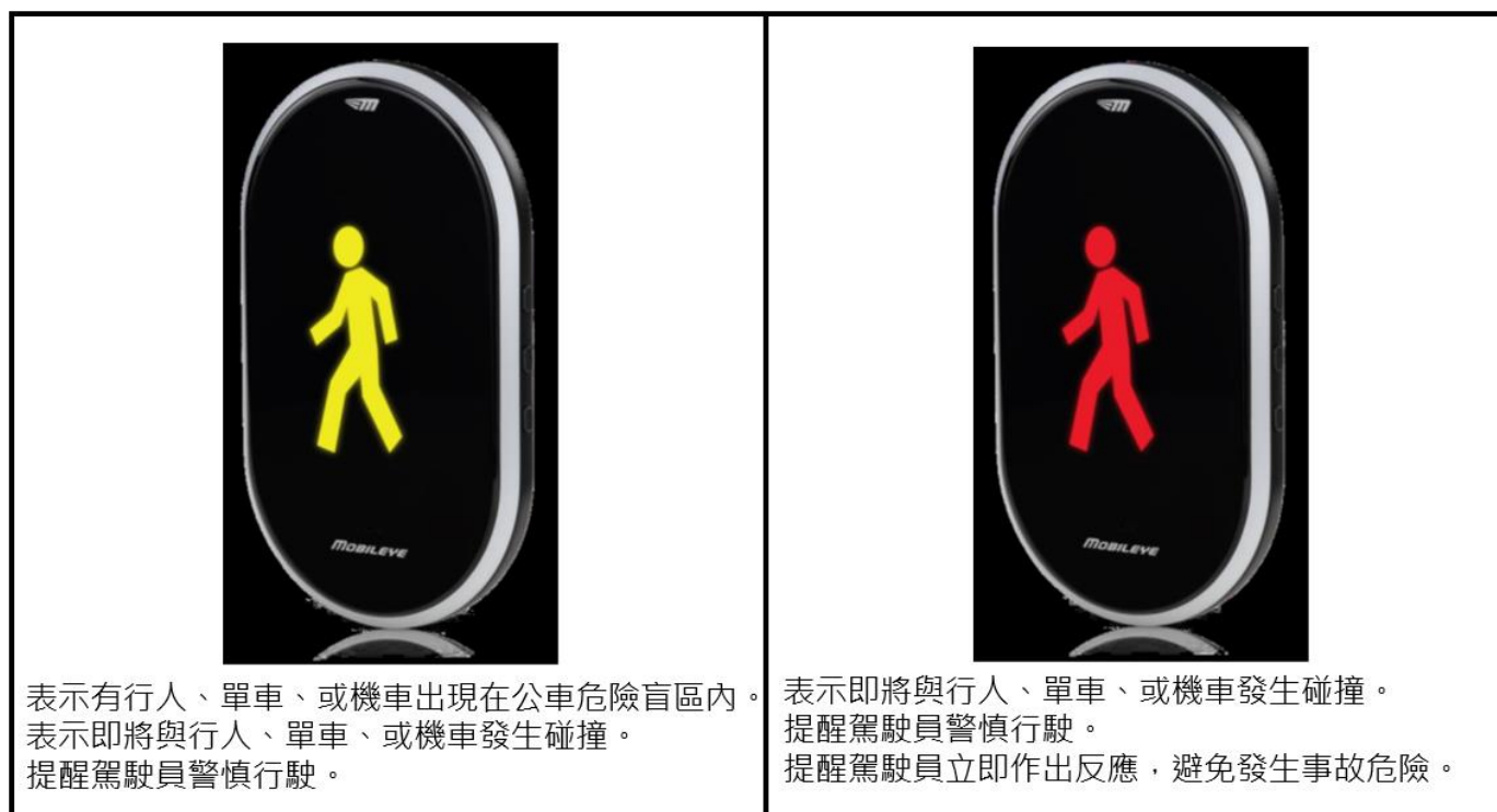
圖 4 盲區偵測顯示器圖示說明
